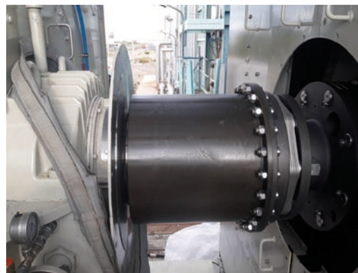
Přední ložisko generátoru (vlevo s ochranou náboje a spojky, vpravo bez)
