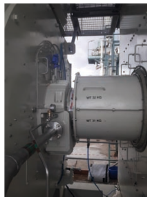
Přední ložisko generátoru (vlevo s ochranou náboje a spojky, vpravo bez)
