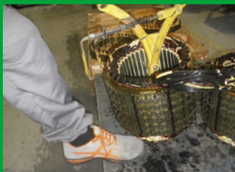
Položení statoru na nohu
