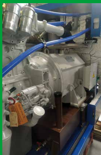
Náš vodou chlazený alternátor připravený na zákazníkův pohon v Tedomu
