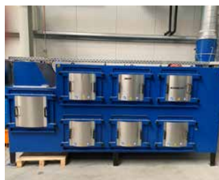
Filtrační jednotka s aktivním uhlím k autoklávy na impregnaci MHV
